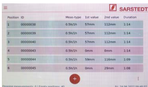
Figura 12: Início de uma medição pressionando a tecla "+"
