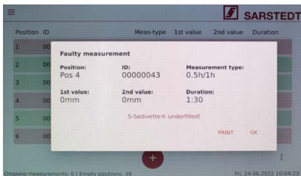
Figura 39: Indicador de eventos com S-Sedivette® insuficientemente cheio
