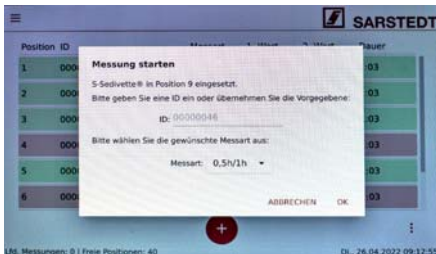
Abbildung 11: Starten einer Messung durch einsetzen einer S-Sedivette®
