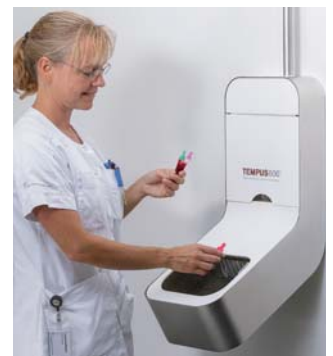
Las muestras se reciben en el módulo de conexión del Tempus600® o en la bandeja de recepción del laboratorio.
