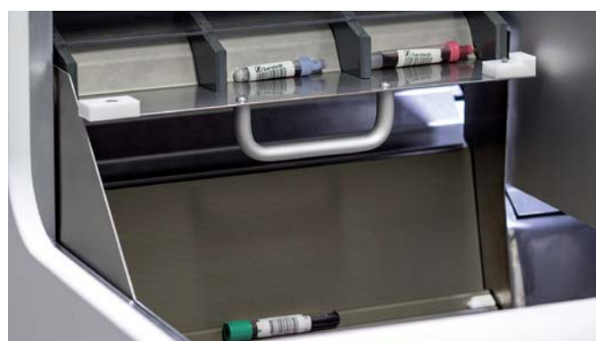
B: Moduł na próbki CITO
