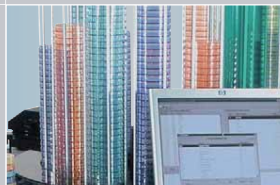
Drehteller für bis zu 15 Nährböden
