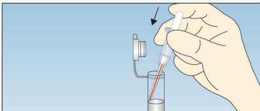
**3b** Alternativ kann die Probe in ein Mikroprobengefäß abgegeben werden.
