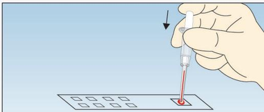
**3a** Die Kapillarspitze auf das Testfeld aufsetzen und durch saches Drücken des Stempels vollständig auf die Testkarte abgeben.
